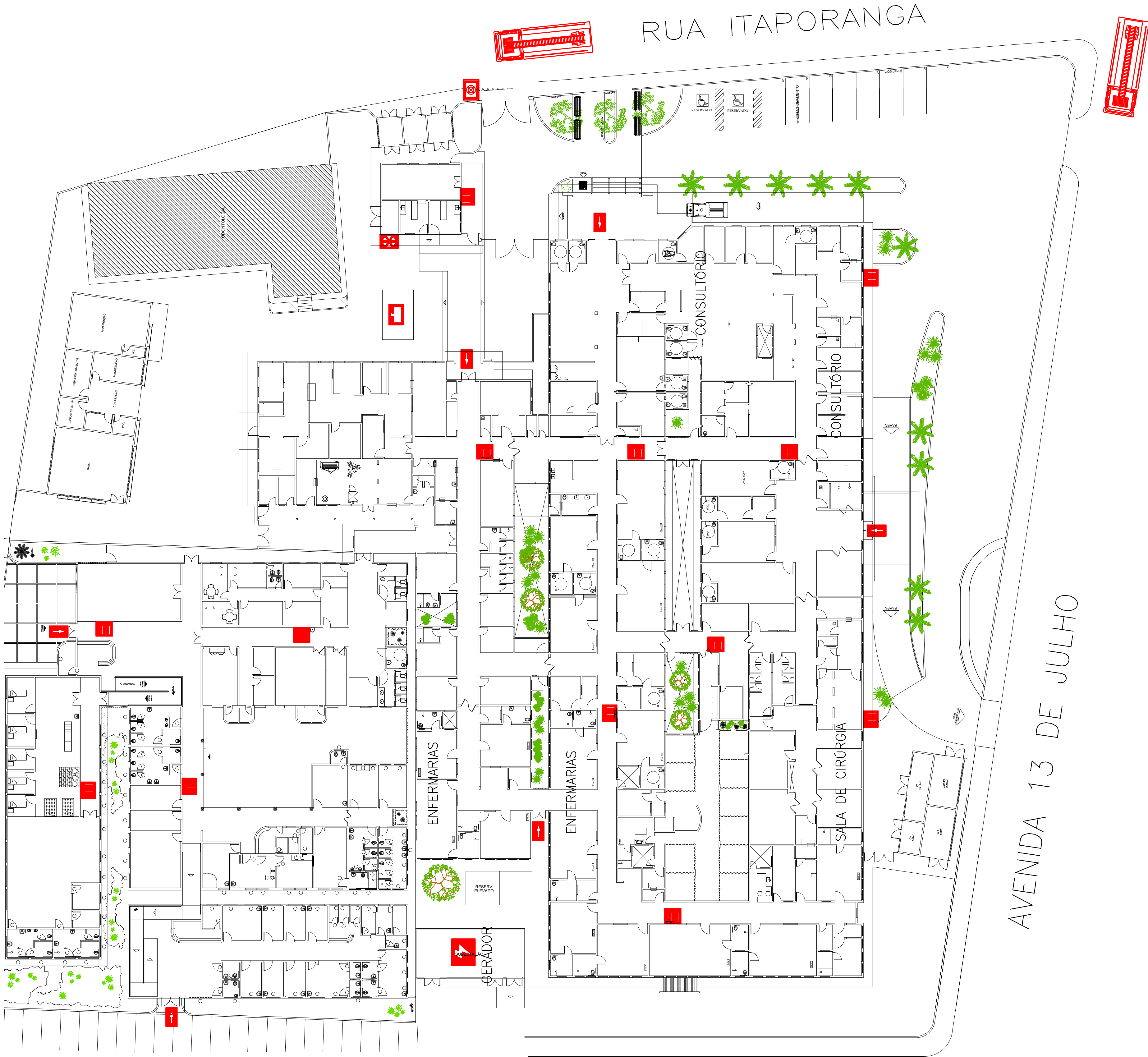
PLANTA DE RISCO DE INCÊNDIO ESCALA 1/250
